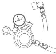
**GAS ANSCHLUSSSET (30 mbar, 1 Anschluss Schlauch) [4988222]**
